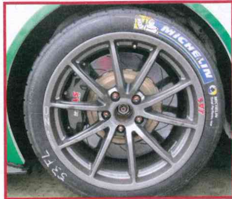
Frenos AP de 6 pistones delante, llantas OZ de 18 pulgadas y neumáticos Michelin.
