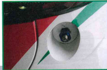
Como buen coche de circuitos, cuenta con gatos hidráulicos. En la foto, la toma de aire para activarlos.
