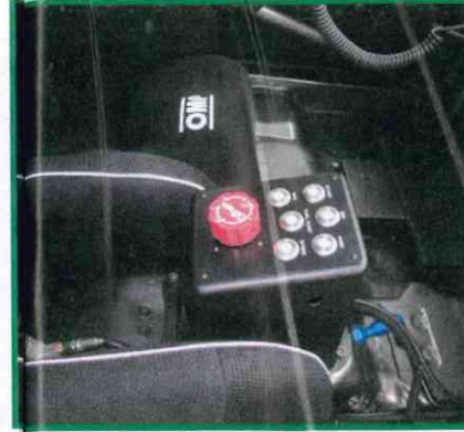
La consola central dispone de varios mandos, entre ellos el arranque y el regulador de frenada.
