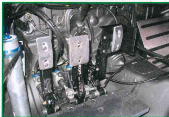
El pedalier es de la firma Tilton. El acelerador cuenta con un tope para que no se salga el botín.
