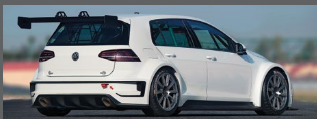
Chassis mais largo 40 cm, rodas de 18", elementos aerodinâmicos em carbono e tudo para a equipa Englester evoluir com o apoio da fábrica
