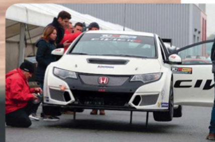
VÉRINS | Les vérins prévus pour les courses d'endurance (notamment les 24 Heures Series) sont en option.
