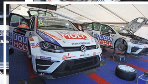
Kostengünstige Technik In der TCR fahren Kompaktwagen mit rund 330 PS und Frontantrieb. Exotische Leichtbaumaterialien sind verboten. Der Preis darf nicht über 100 000 Euro steigen
