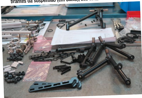
Em cima, é bem visível a quantidade de peças de carroçaria que vem diretamente da linha de produção de série. Outras, como os tirantes da suspensão (em baixo), são feitas na Seat Sport
